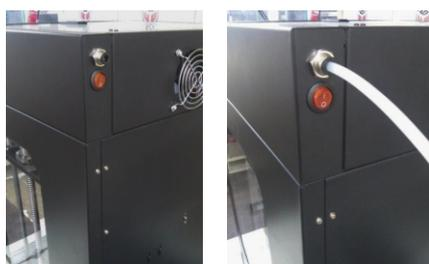
Inserte los extremos de las mangueras internas que han quedado sueltas, en los acoples de la parte en la conexión interna del racord considerando no cruzar los conductos entre sí.
