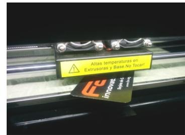
Ésta sería la posición exacta para que las boquillas depositen el material fundido de manera correcta.
