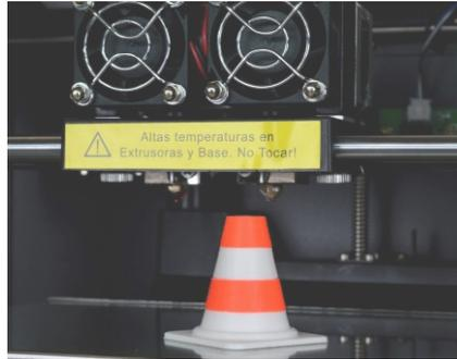
– **Combinación distintos materiales:** mientras una boquilla esté trabajando con un sólo material, al terminar este proceso el otro puede imprimir partes del modelo sin la necesidad de pausar la impresora para cargar uno diferente. Por ejemplo, puede ir creando un soporte en zonas de difícil acceso, que resulten sencillo de eliminar.
