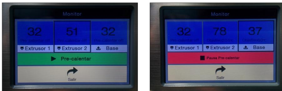
El casillero izquierdo corresponde al control de temperatura de la boquilla extrusora izquierda (nº1), el casillero central de la boquilla extrusora derecha (nº2) y por último el casillero derecho a la temperatura de la base de impresión.
